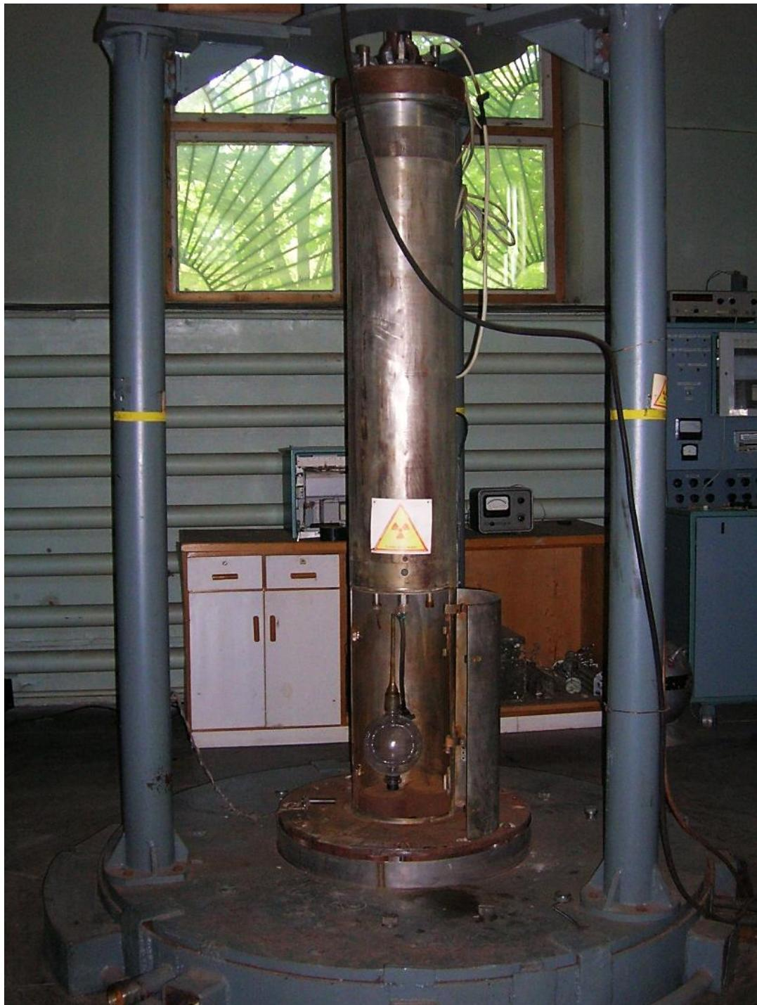
Предназначена для проведения в зоне радиации (гамма-излучение на основе радионуклида кобальт-60) жидкофазных проточных процессов и облучения твердых объектов. Установка состоит из облучателя типа «беличье колесо», грузоподъемных механизмов (Электроталь Т-10432, Электроталь ТЭ-320, кран однобалочный подвесной с электроталью ТЭ-500). Установка укомплектована 32 источниками Со-60 типа ГИК-7-4. (10.08.1987 г.). В настоящее время суммарная активность - 69.76 ТБк.
