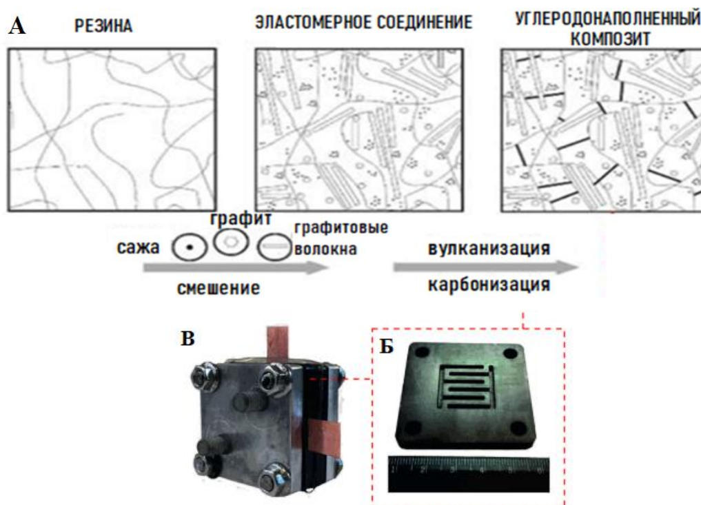
Рисунок 8 - Схема процесса изготовления (а); БП из КМ (образец ЭК-ФК-3) (б); прототип ВПБ (в)
