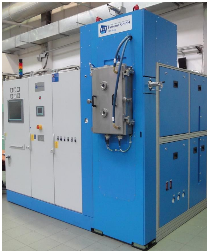
Рисунок 2.14 – Установка искрового плазменного спекания
