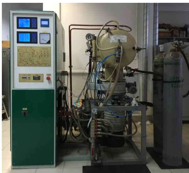
Рисунок 2.12 – Вакуумная электрическая печь типа СНВЭ-1.3.1/16-ИЗ
