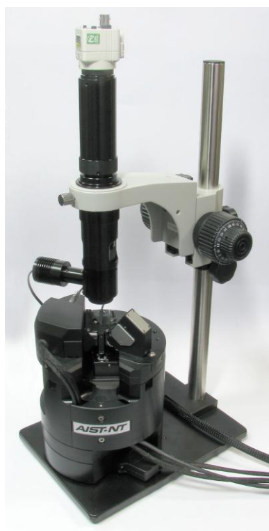
Рисунок 2.3 – Атомный силовой микроскоп Aist-NT SmartSPM
